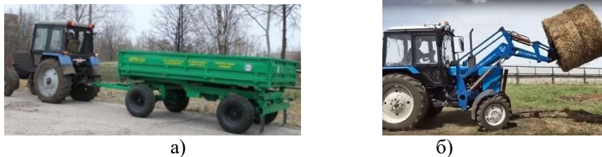
Рисунок 1 - Тракторный транспортный агрегат в составе трактора класса 1,4 и 2ПТС-4,5 (а) и погрузчик ПКУ-0,8 (б)
