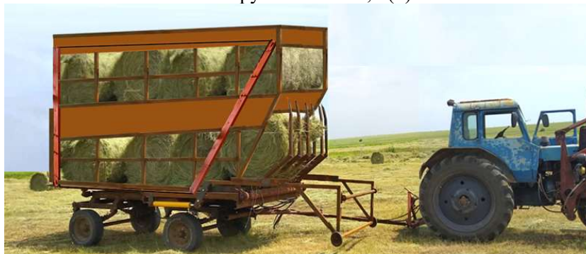
Рисунок 2 - Тракторный транспортный агрегат в составе трактора класса 1,4 и ПТРМ-2
